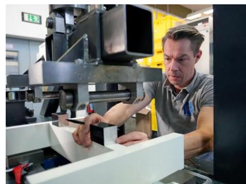
Prüfungen an Pfosten-Riegel Verbindern und Glasauflager nach EN 16758 und EN 17146 erleichtern Berechnung sowie baurechtliche Anerkennungen (abZ, ZiE und vBg)
